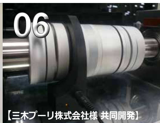
リングコイル + C 型コイル トルクセンサへの給電
